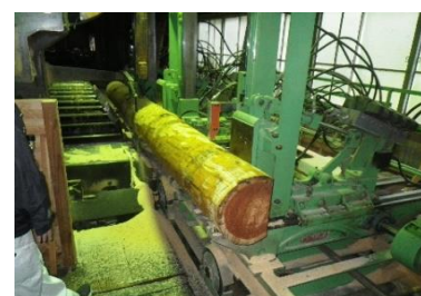
必要な幅、厚さの角材や板材に製材される
