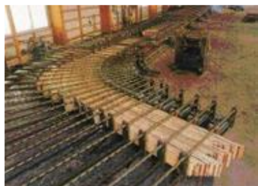
建築物によっては、板材を重ねて、大断面集成材等に加工
