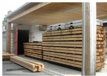
乾燥機で適正な含水率まで乾燥し、ねじれや割れを抑える
